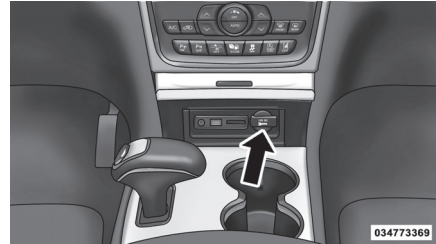
Ön Elektrik Prizi
