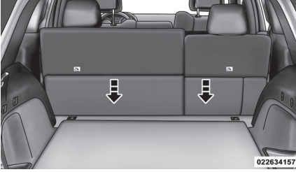
Üst Bağlantı Kayışına Erişmek için Halı Zemin Panelini Aşağı Doğru Çekmek
